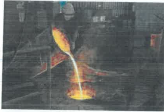
Figure 1: Molten metal pour out from ladle
