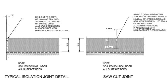
TYPICAL ISOLATION JOINT DETAIL
