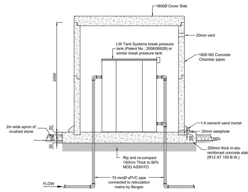
**BREAK PRESSURE TANK CHAMBER DETAIL**
