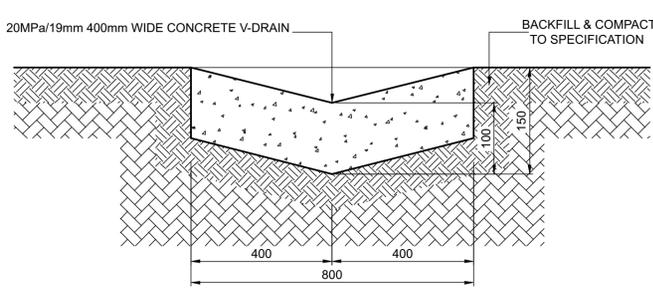
**SECTION B - B CONCRETE CHANNEL**
