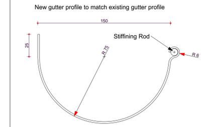
**Detail 100-03 - GUTTER DETAIL**
